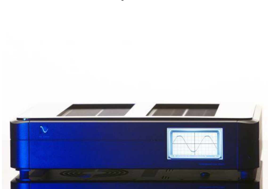
DER TOUCHSCREEN DES POWER PLANT P5 ZEIGT DEN SINUS, DER AN DEN AUSGÄNGEN ANLIEGT
